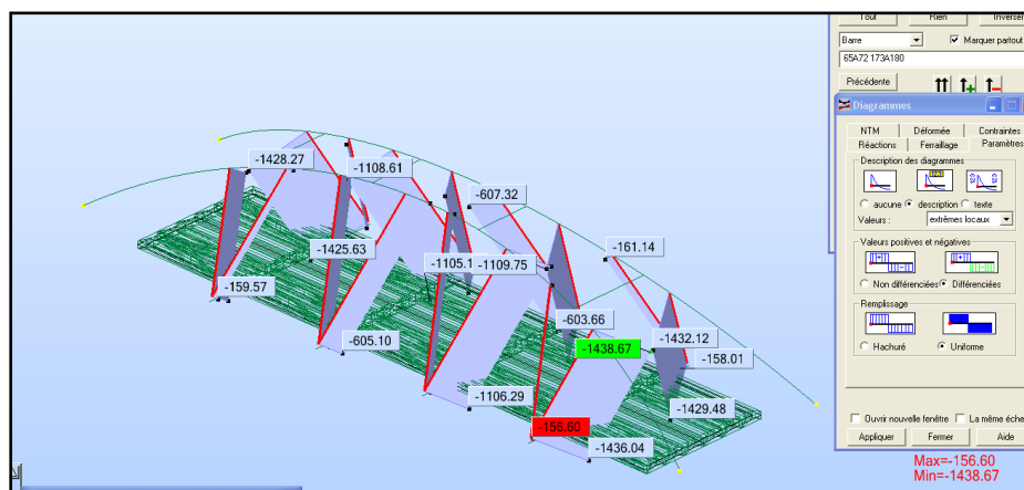
Figure A.V.35. Diagramme de l'effort normal des câbles
