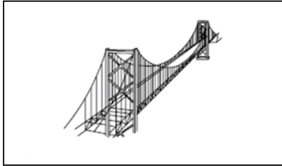
Fig. II.4 Suspension à double nappe
