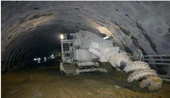
**Figure II.2** Machine à attaque ponctuelle
