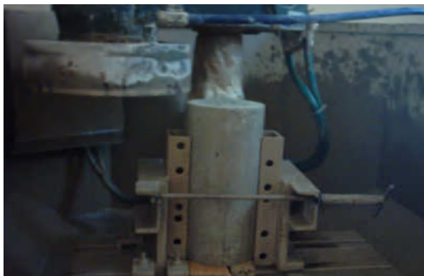
Photo 3.1 : Surfaçage mécanique des éprouvettes de contrôle
