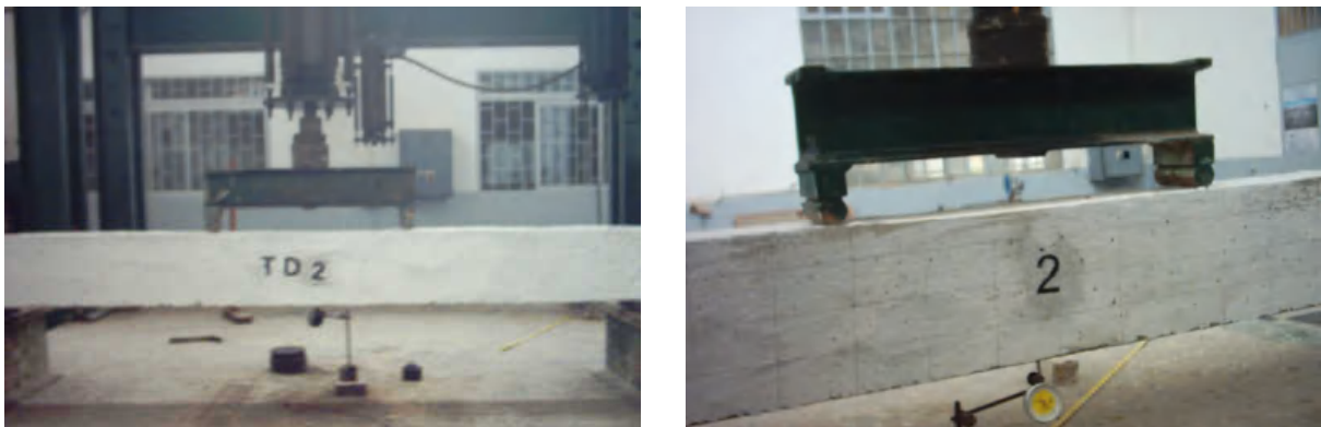
Figure 8 : Poutres témoins en cour du chargement
