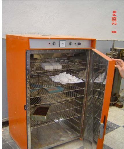
Armoire thermostatique (Etuve)
