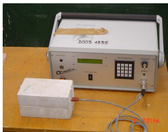
CT Métré avec deux éprouvettes (4x8x16cm)
