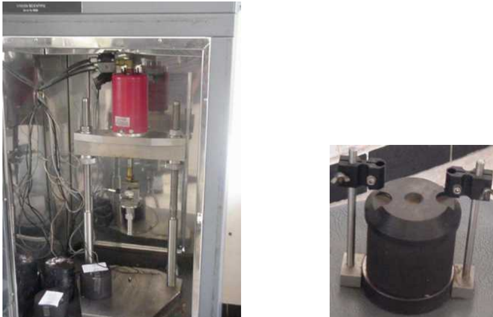
Figure V.5. : « Matériel utilisé dans l'essai de fluage statique »
