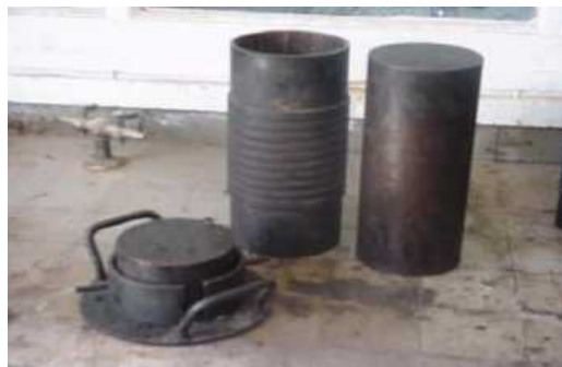
Figure 4.9 moule de l'essai duriez dilaté
