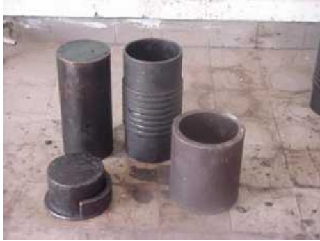
Figure 4.8 moule de l'essai duriez simple
