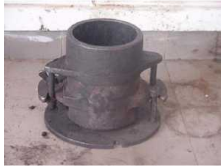
Figure 4.10 moule de l'essai MARSHALL
