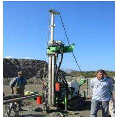
Figure. 7-2 Standard Pénétration Test
