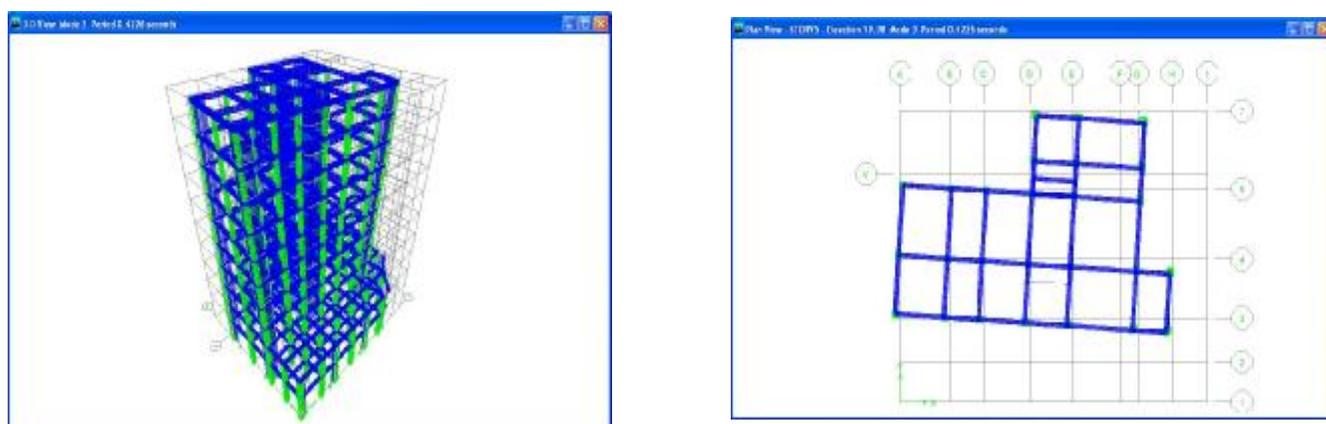
Fig. V.7: Troisième mode de vibration. Vue 3D et vue en plan
