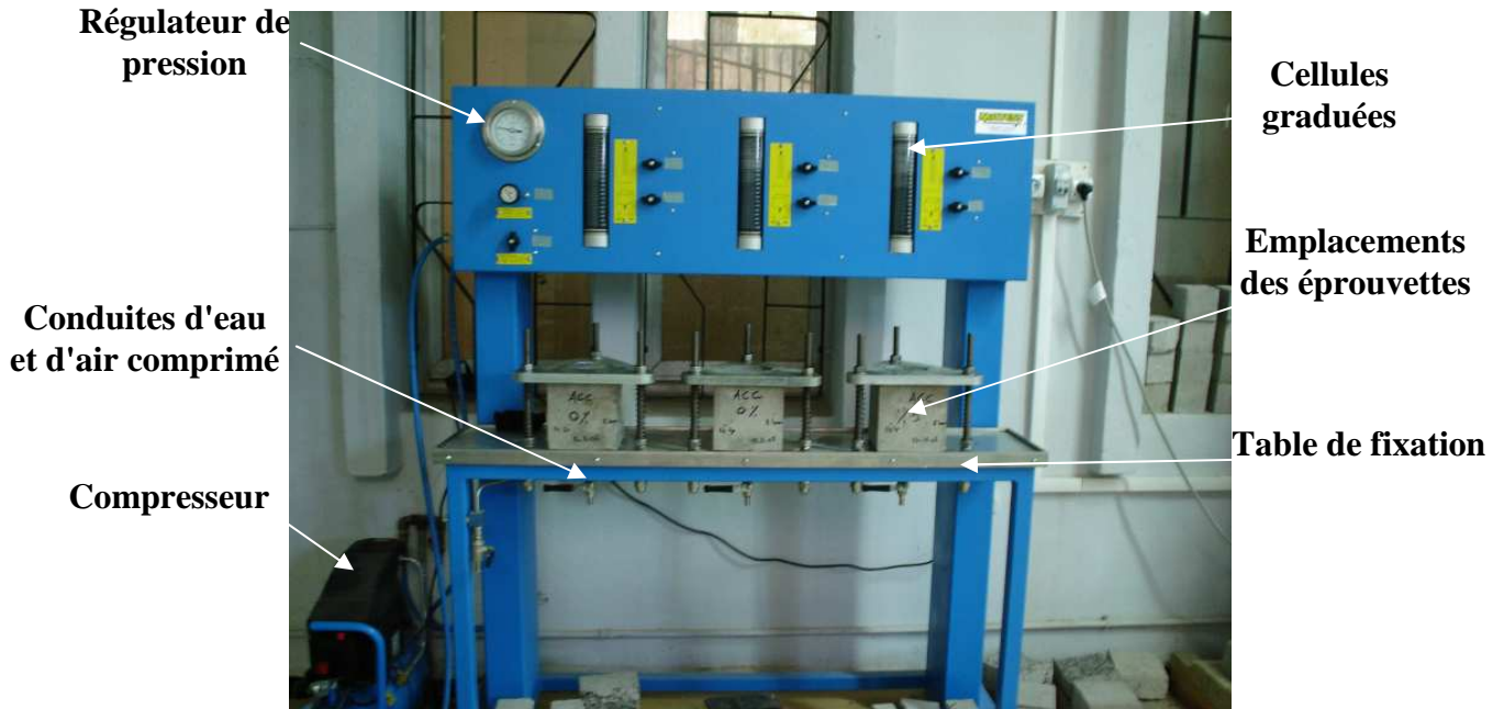
Figure II.8: Essai de perméabilité de béton à l'eau.
