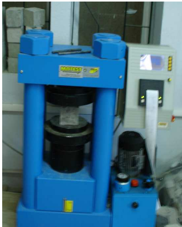
Figure II.7: Essai de compression sur éprouvettes cubiques
