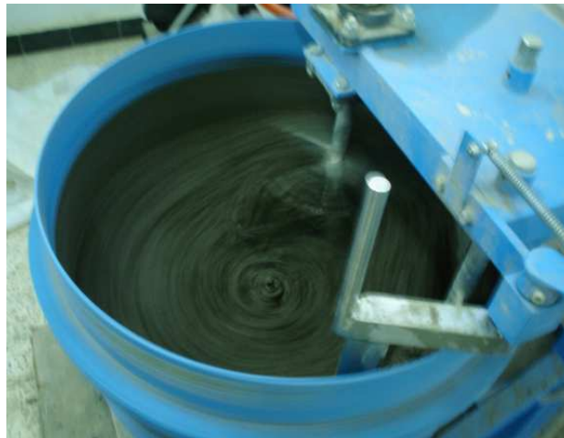
Figure II.4: Malaxeur à béton de capacité 56 Litres
