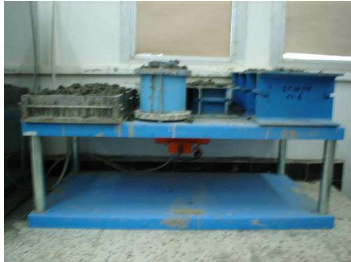
Figure II.5: Les éprouvettes préparées dans les moules sur la table vibrante
