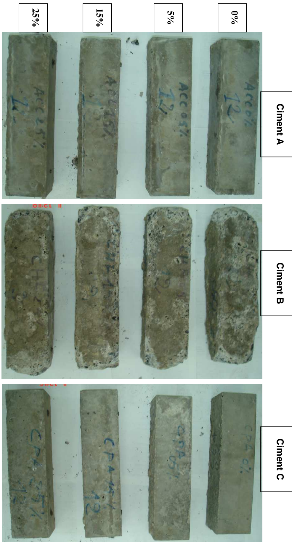
Figure III.13: Etat des éprouvettes de béton après 360 jours d'immersion dans 5% Na 2 SO 4 pour les trois ciments utilisés
