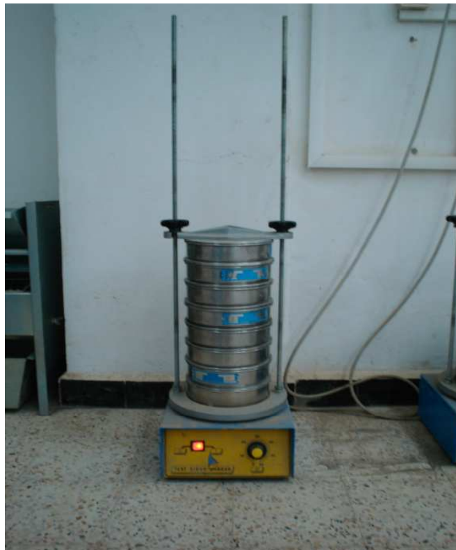
Figure II.1: Tamiseuse électrique utilisée pour la récupération des fines calcaires
