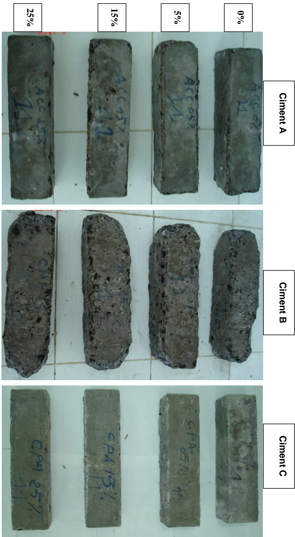
Figure III.12: Etat des éprouvettes de béton après 360 jours d'immersion dans 5% MgSO 4 pour les trois ciments utilisés
