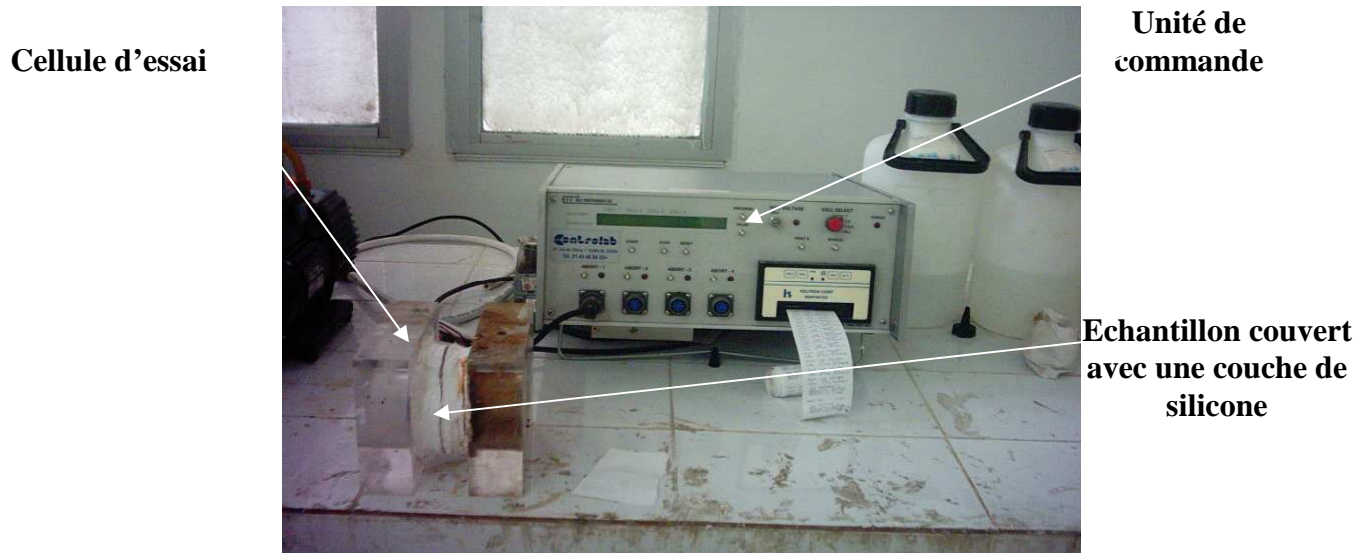
Figure II.10 Photo de l'essai de perméabilité de béton aux ions chlore.
