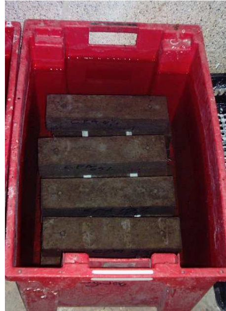
Figure II.16: Immersion des éprouvettes dans une solution de sulfate de magnésium 5% ( \text{MgSO}_4 ).
