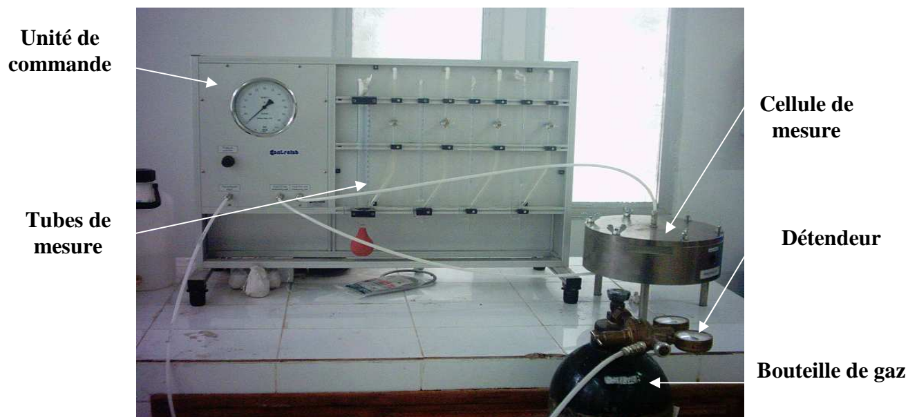
Figure II.12: Photo de l'essai de perméabilité de béton au gaz
