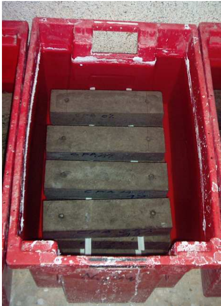
Figure II.15: Immersion des éprouvettes dans une solution de sulfate de sodium 5% ( \text{Na}_2\text{SO}_4 )
