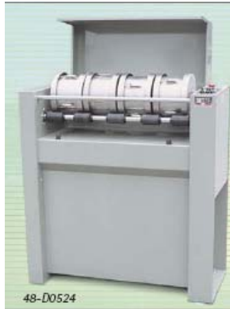
Photo VI.3 : dispositif d'essai Micro Deval. [28]
