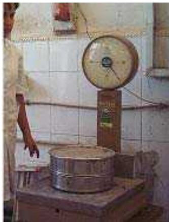
Figure VII.4 : essai de stabilité au tamis
